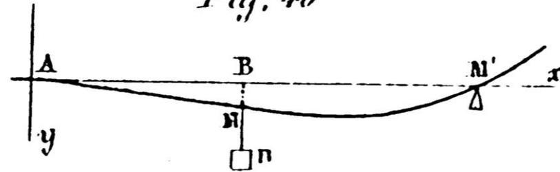
ÉQUILIBRE D'UNE PIÈCE CHARGÉE D'UN POIDS, DONT L'UNE DES EXTRÉMITÉS EST ENCASTRÉE ET L'AUTRE EXTRÉMITÉ POSÉE SUR UN APPUI.
