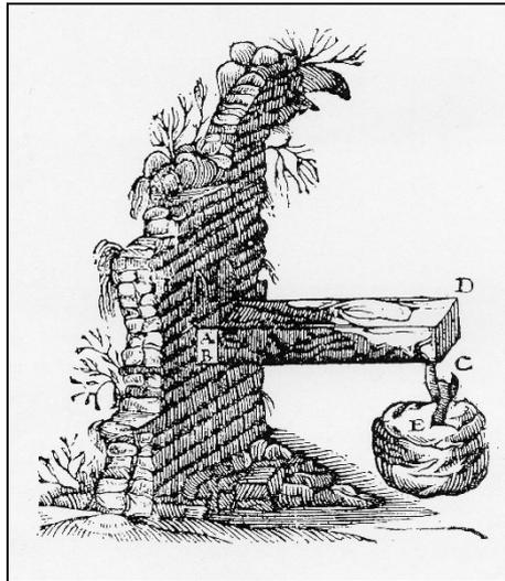
Galileo introdusse il concetto di “resistenza” avente un valore finito (si tratta di una forza, non di una tensione). Il suo è un calcolo a rottura, estraneo al problema della deformazione: la trave è considerata *materiale* (vale a dire fatta di materia e quindi soggetta a rottura), ma rigida.
