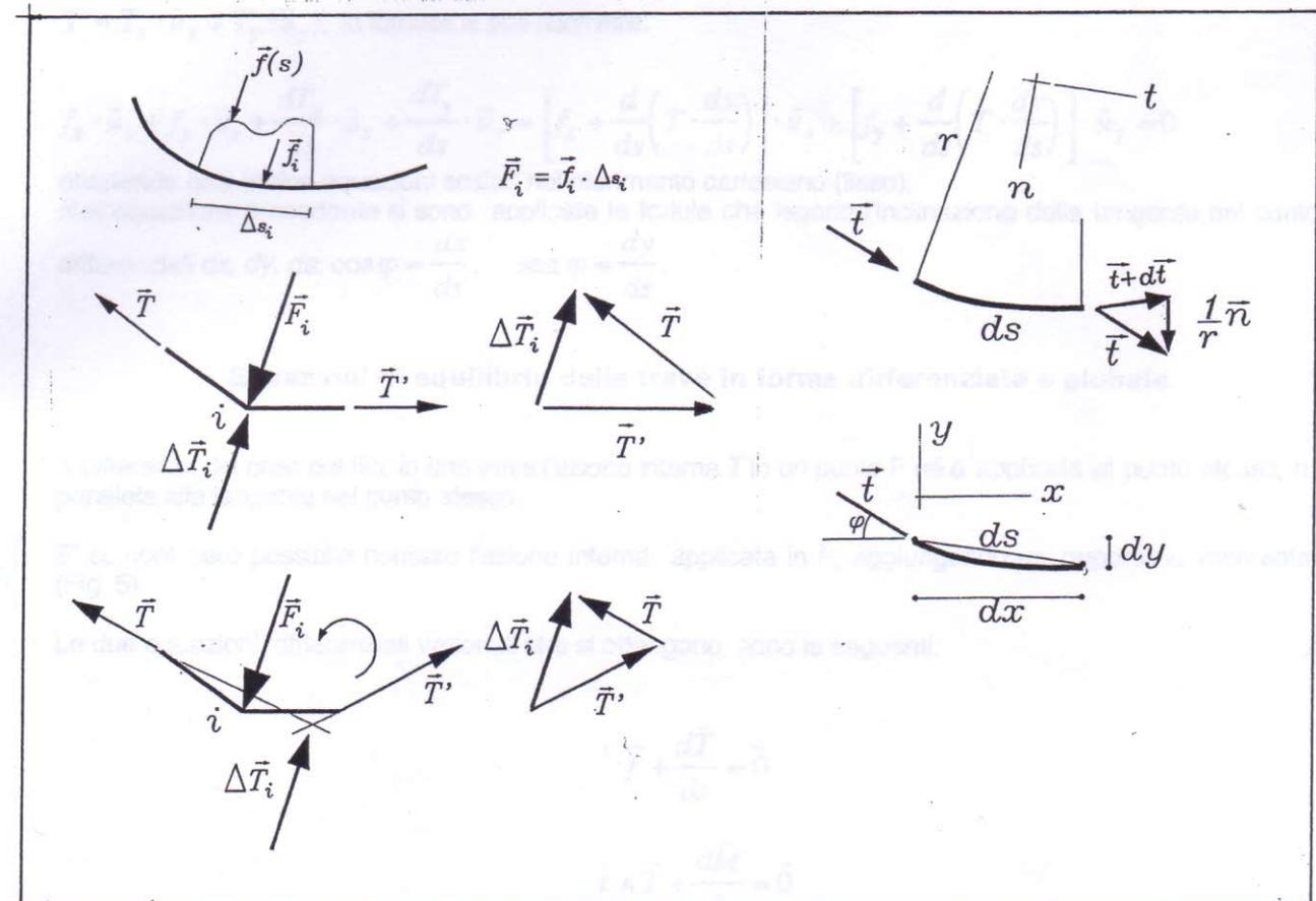
Fig. 4 - Equilibrio di un filo. Sistemi di riferimento intrinseco e cartesiano
