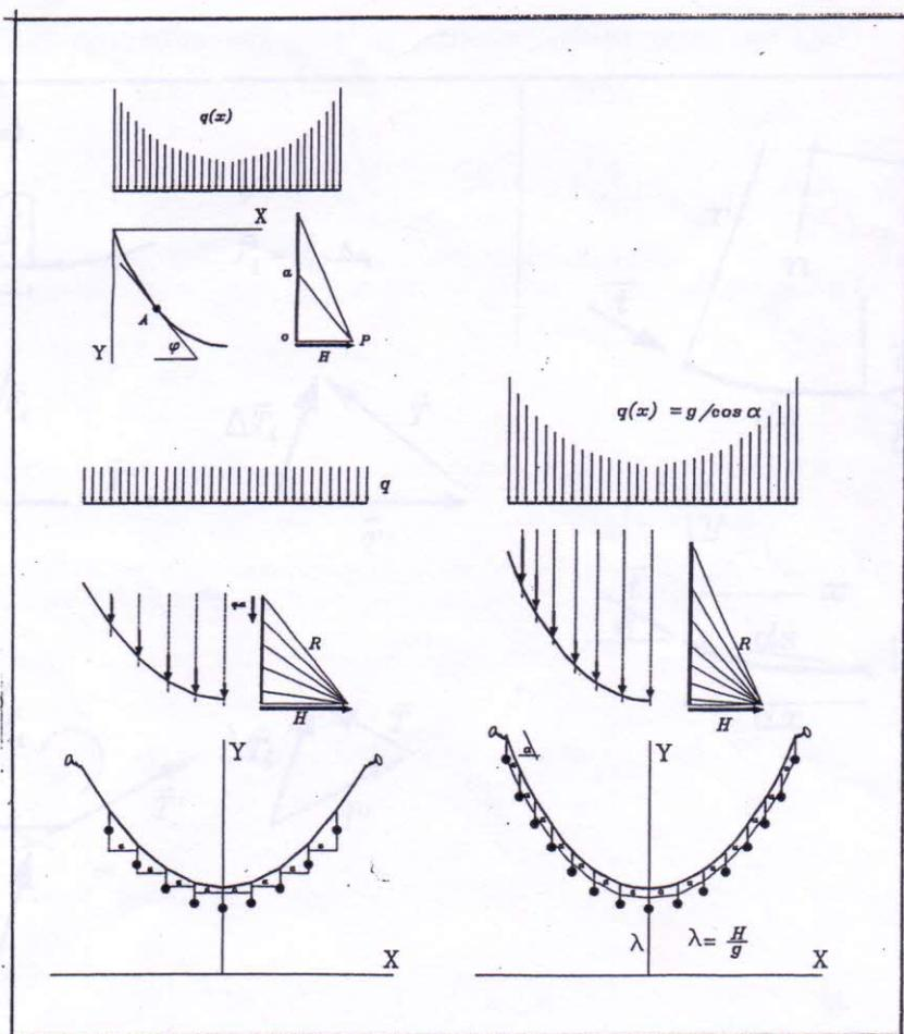
Fig. 3 - Funicolare parabolica e catenaria
